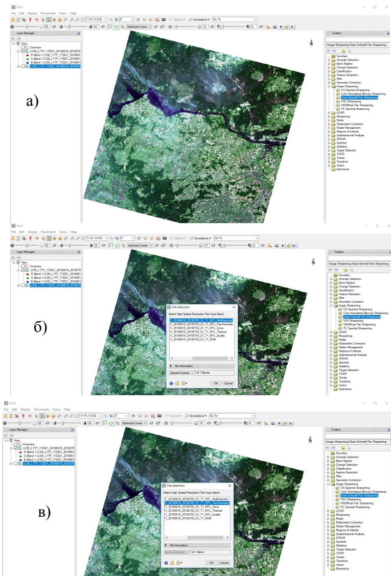
Рисунок 3.22 – Последовательность действий по проведению паншарпинга: а) использование преобразования «Грамм-Шмидта», б) выбор снимка низкого разрешения, в) выбор снимка низкого разрешения
