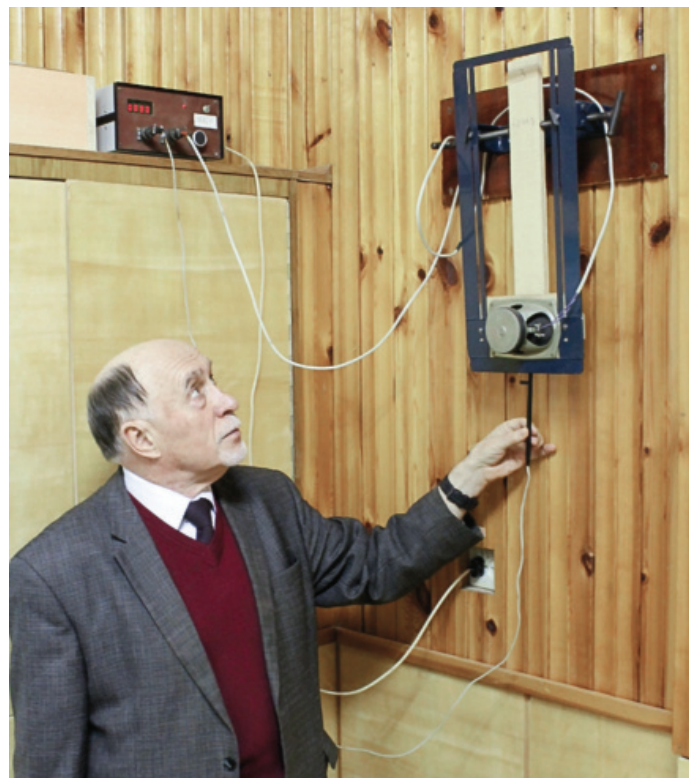
Общий вид прибора для отбора резонансной древесины в заготовках путем определения собственной частоты методом обратной акустической связи
