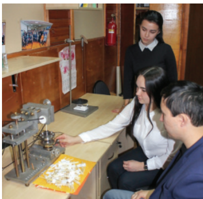
Фрагмент прибора с консольным типом крепления образца в виде радиально-поперечного керна для определения частотно-амплитудных показателей древесины неразрушающим способом
